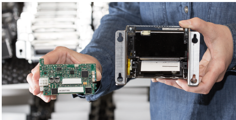
Alternative zum Einbaudrucker: Trennung von Ansteuerung und Mechanik
